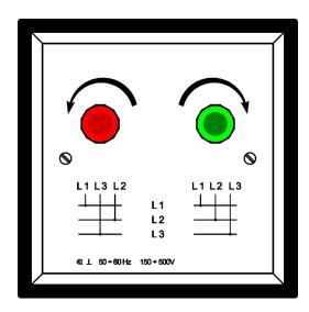
Der Drehfeldrichtungsanzeiger ISF-72 ISF-96 wird zur Feststellung der Phasenfolge in einem Drehstromnetzen bis 500 V verwendet.
