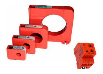
Die Differenz-Stromwandler der Baureihe DACT wurden in Verbindung mit dem Fehlerstrom-Relais DACT-ELR für die Erfassung von Differenzströmen (Erdfehlerströmen) Typ A konzipiert. In dieser Kombination erfassen Sie Fehlerströme in zwei Bereichen von 0,02 ... 2 A und 0,25 ... 25 A.
