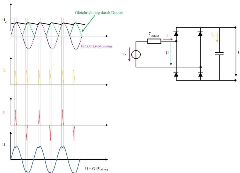
Abbildung 1: Brückengleichrichter im impulsartiger Stromentnahme
