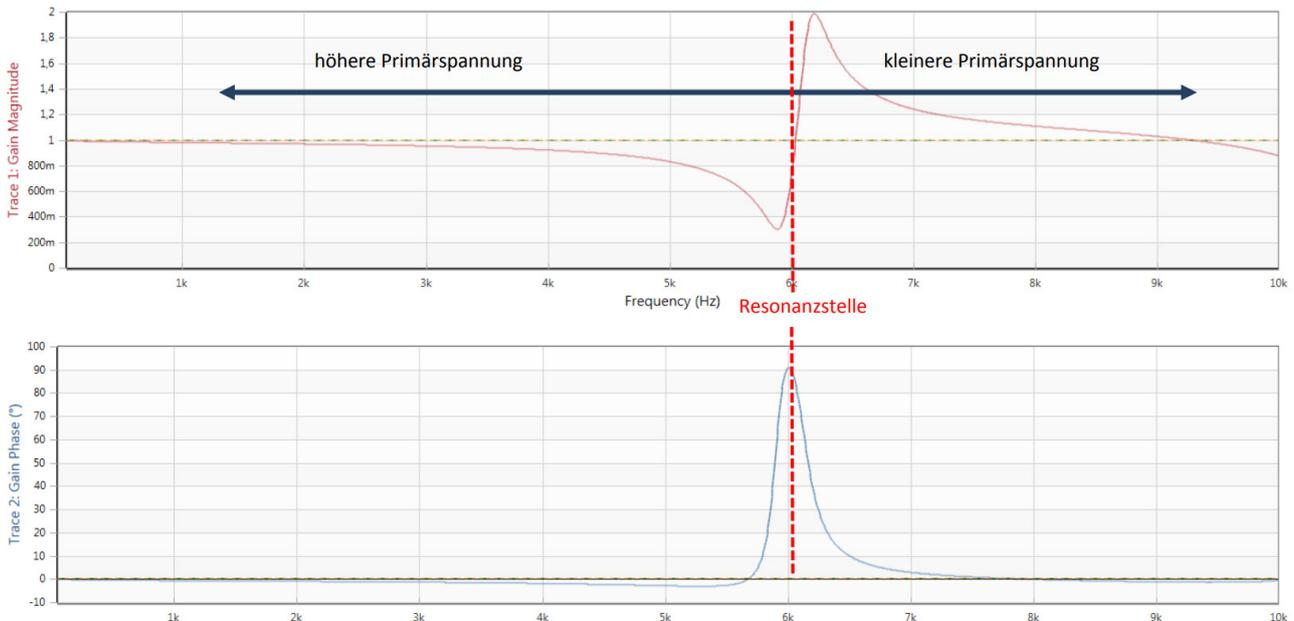
Abbildung 1: Frequenzübertragungsverhalten eines 10 kV Spannungswandlers mit hochohmiger Bürde
