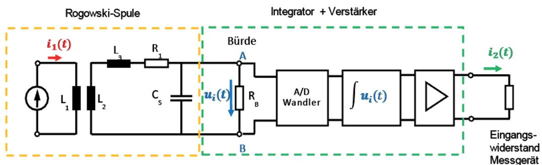
Abbildung 3: Elektrisches Ersatzschaltbild Rogowski-Spule + 1 A Integrator
