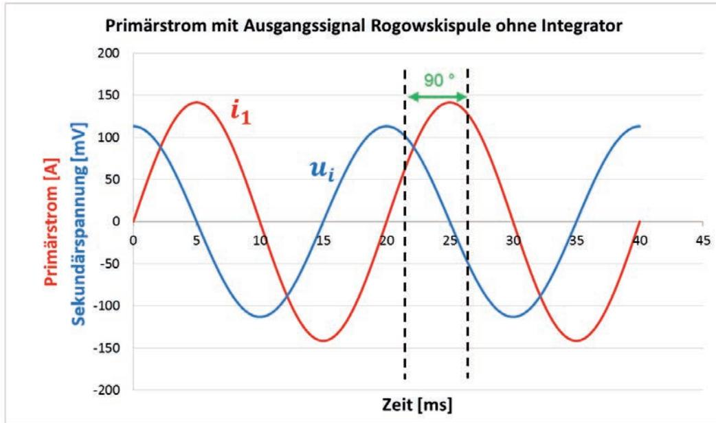
Abbildung 2: Primärstrom und Ausgangssignal einer passiven Rogowski-Spulen im Vergleich
